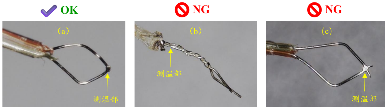
图 3 热电偶的测温位置
